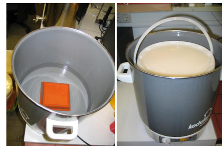
Abb. 14 - Wiederverflüssigen im Wasserbad: Einstellen des Vorratsbehälters ins Wasserbad auf eine Unterlage, Deckel muss dicht sein, nicht über 40° C erwärmen.
