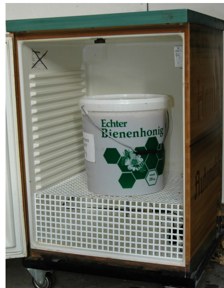
Abb. 15 - Wiederverflüssigen in selbstgebauten Wärmeschrank: sicher und schnell. Foto: Jörg Sterling
